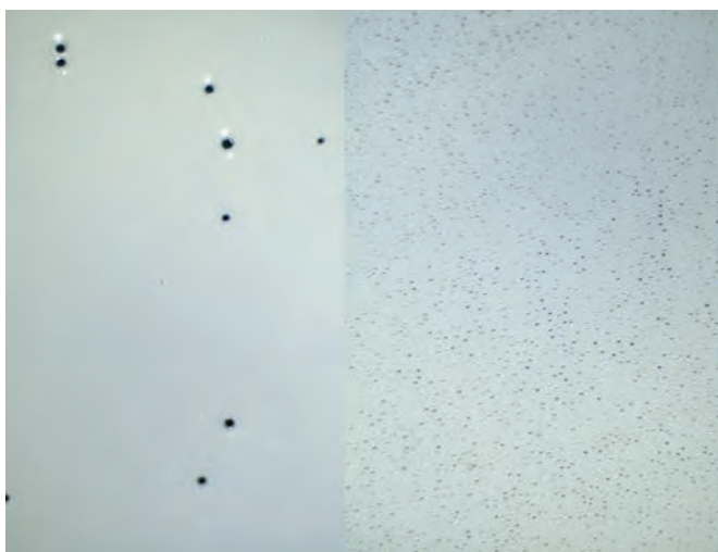
Дефекты покрытия (высокоглянцевая эмаль) без добавления противовспенивающего средства Silair™ C 400
