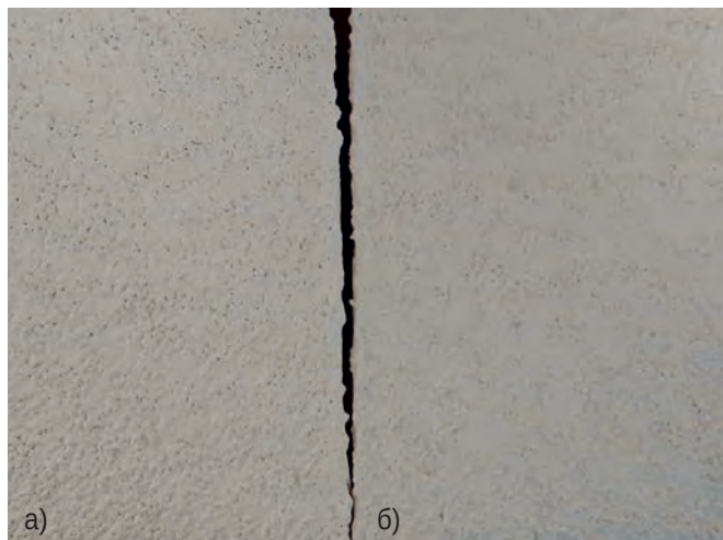
Сравнение штукатурки без пеногасителя (а) и с добавлением пеногасителя WS 935 (б)
